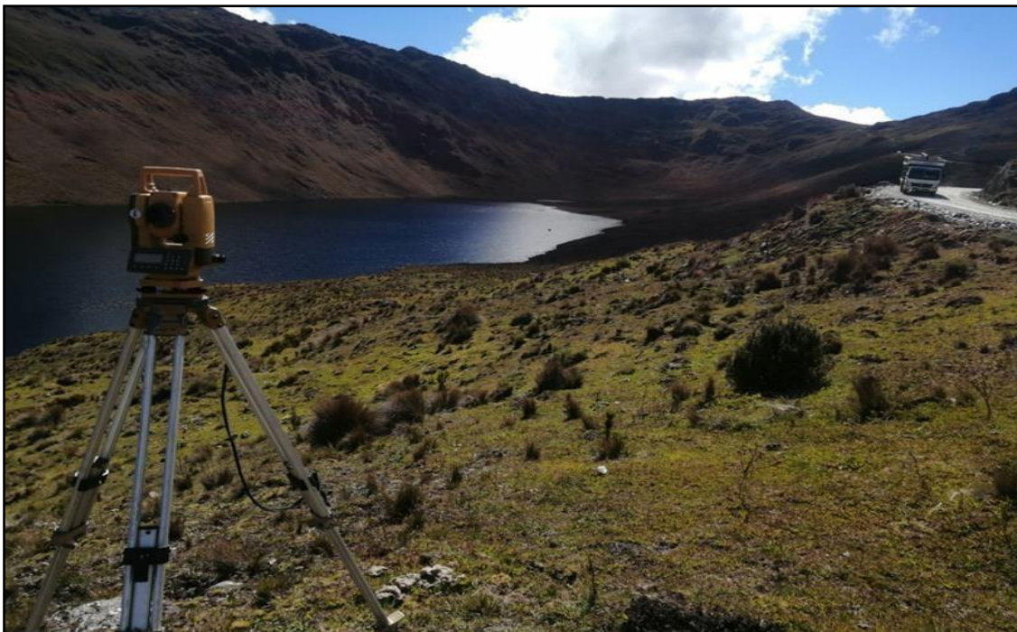
Figura 10. Equipo de estación total utilizado en levantamiento topográfico-Laguna Huascacocha, Tayabamba, Pataz, La Libertad.
