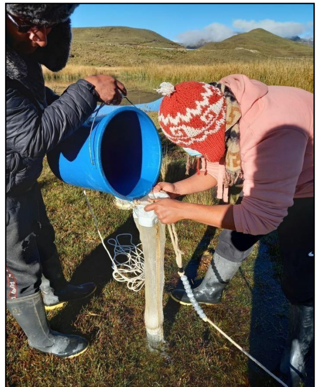
Figura 14. Filtración de agua para posterior análisis de fitoplancton-Laguna Huascacocha, Tayabamba, Pataz, La Libertad.
