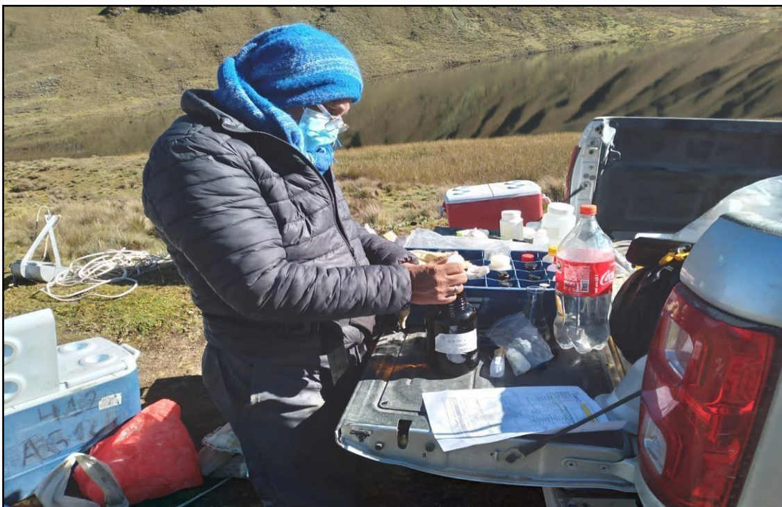
Figura 3. Toma de muestras y análisis “in situ” del agua para determinar parámetros químicos. Laguna Culluna, Tayabamba, Pataz, La Libertad.
