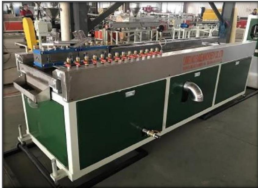
**FIGURA 08: MÁQUINA DE ENFRIAMIENTO CON TABLERO DE CONTROL DE PARÁMETROS**
