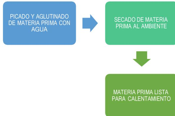
Para este procedimiento, se utilizará un molino con tanque vertical para picar y aglutinar el plástico (fundas), de alta y baja densidad en pequeñas aglomeraciones, con tapa manual para la salida del material,<sup>16</sup> conforme se muestra en la figura 01. Es importante mencionar que el personal responsable siempre debe seguir el procedimiento de uso, como se muestra a continuación:
