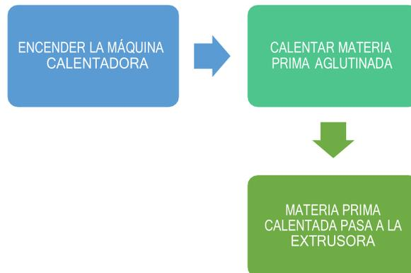
El proceso seguido es encender la máquina calentadora, colocar la materia prima aglutinada dentro de la tolva mientras la máquina extrusora se calienta y finalmente la materia prima, lo suficientemente caliente, pasa a la extrusora.
