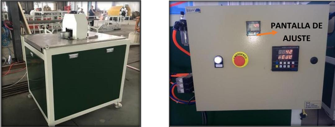
12. Para facilitar la recolección de esquineros se dispondrá de una apiladora al final de la línea de producción, como se muestra en la figura 11.
