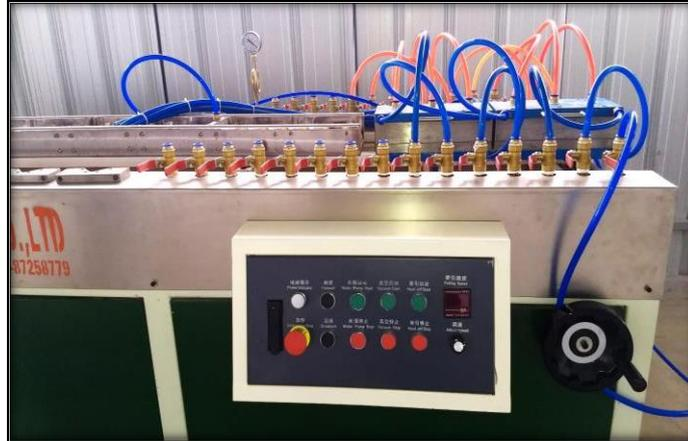
9. Para continuar con el proceso, la línea de producción cuenta con una máquina tensora de manejo sencillo de fácil acoplamiento a la máquina extrusora, para lograr el tirado de los perfiles,<sup>18</sup> como se muestra en la figura 09.
